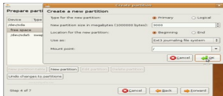
รูปที่ 9 แสดงการจัดการ Partition แบบ Manual
